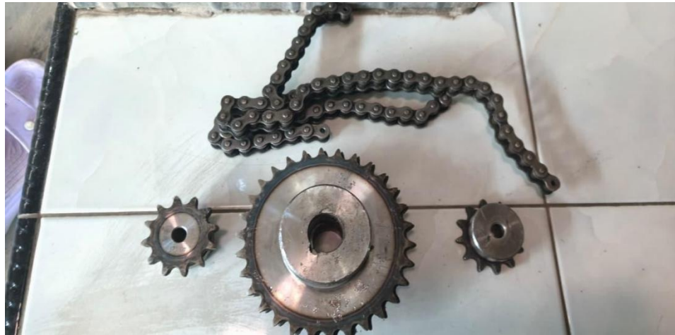
Gambar 4.1 Hasil Fabrikasi Roda Gigi Baja Cor SC 49
