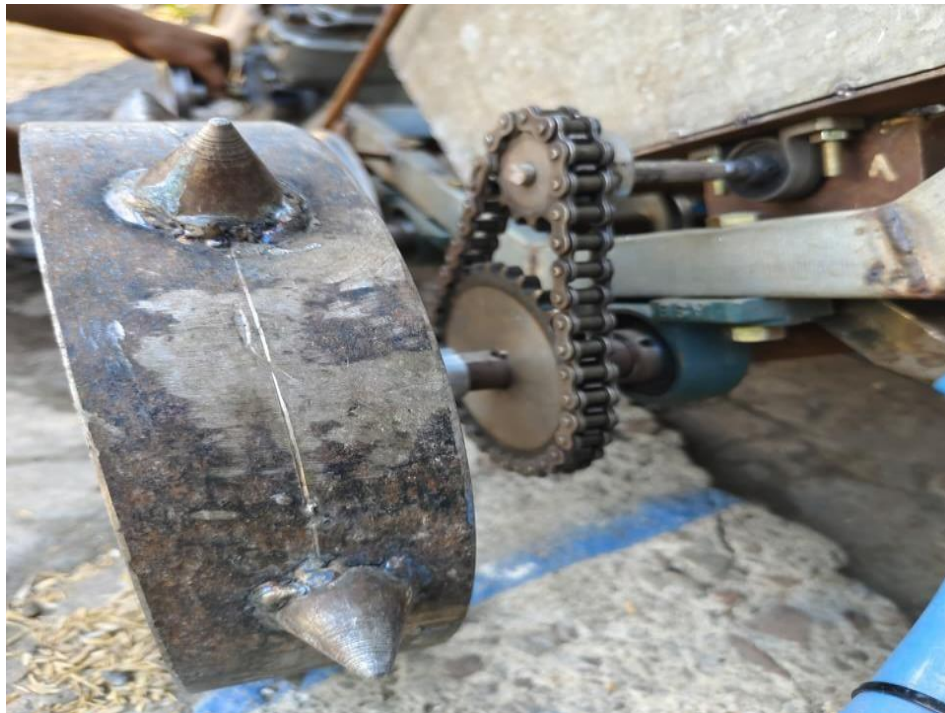
Gambar 4.2 Pemasangan Roda Gigi Baja Cor SC 49
